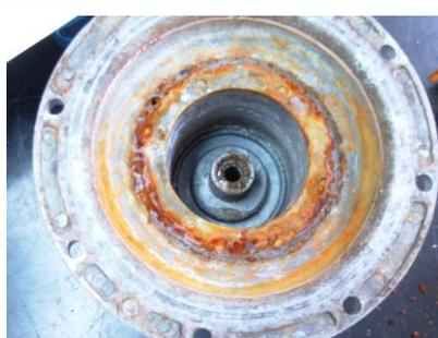
カバー内部の腐食
