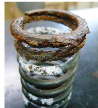
調整ばねの腐食
