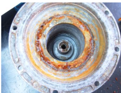
カバー内部の腐食
