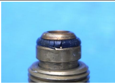
POLのOリング亀裂
