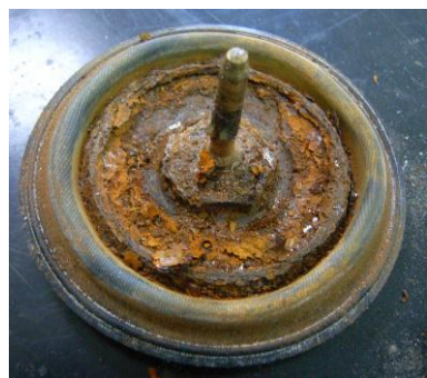
受圧版の腐食
