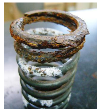
調整ばねの腐食
