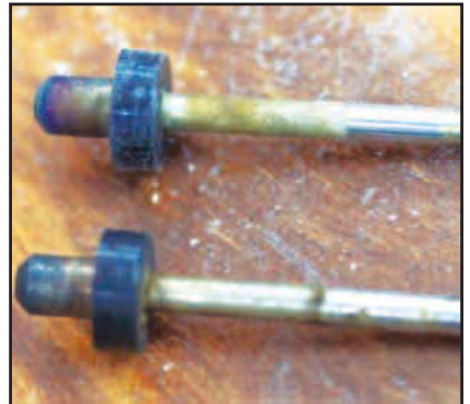
中圧弁棒摺動部へのドレン固着 (経過年数9年)
