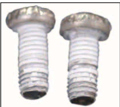
本体のアルミが腐食 (経過年数8年)
