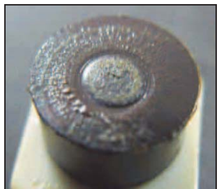
低圧弁ゴムのノズル跡 (経過年数9年)
