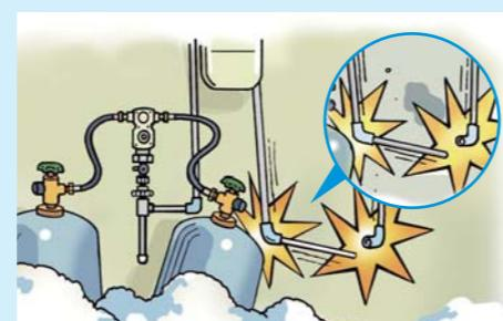
積雪によりLPガス容器に荷重が加わり、配管の継手部が破損する例
