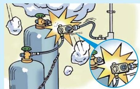
屋根から落下する雪で容器に直結した片側自動切替調整器が破損する例
