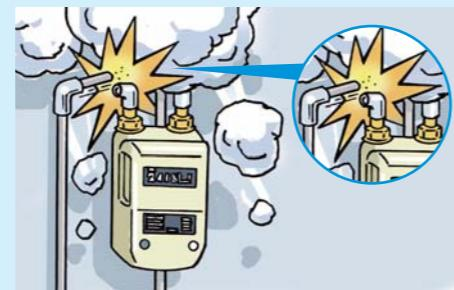
屋根から落下する雪がガスマーターに落下し、供給管が破損する例
