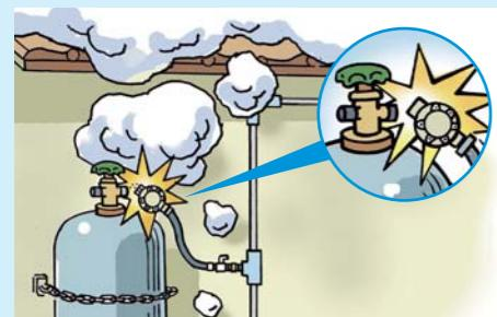
屋根から落下する雪で容器に直結した単段調整器が破損する例
