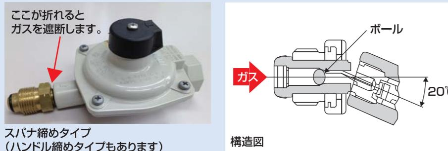
折損対応型单段調整器は、地震や台風で瓦が落ちたり落雪等で調整器に異常な重量が加わったりすると、左図のように入り口接続部が折れ、20℃以上傾くとボールが栓をしてLPガスの流出を防止する機構が付いています。
